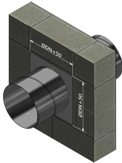
Joonis 9. FDA-BU tuletõkkeklapp. - torude ja sektsiooni süsteemi tihendi mõõtmed.
