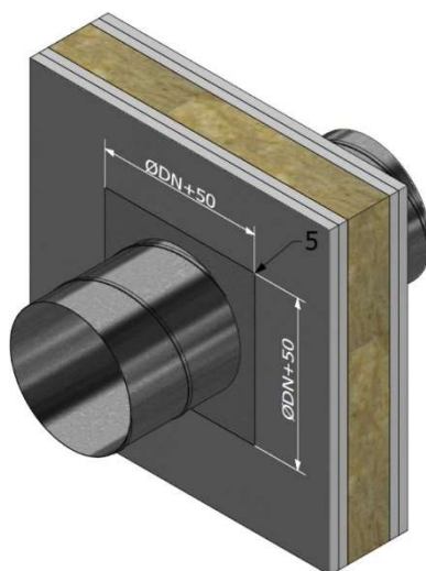
Joonis 14. FDA-BU tuletõkkeklapp. - torude ja sektsiooni süsteemi tihendi mõõtmed.
