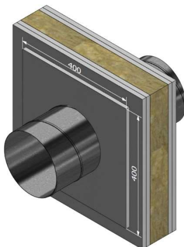
15. FDA-BU tuletõkkeklapp. - 12,5 mm kipsplaatkatte mõõtmed
