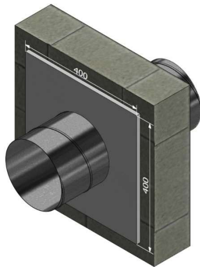
Joonis 10. FDA-BU tuletõkkeklapp. - kipsplaadi mõõtmed 12,5 mm.
