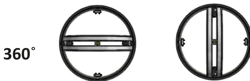
Joonis 4. FDA-BU tuletõkkeklapp. - labade lubatud asend.
