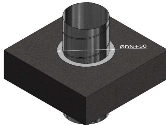
Joonis 12. FDA-BU tuletõkkeklapp. - torude ja sektsiooni süsteemi tihendi mõõtmed.
